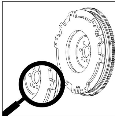
3. Verifique la condición de la superficie del volante, revisando que no presente grietas por sobrecalentamiento o desprendimiento. De presentarse alguna anomalía, es necesario rectificar o reemplazar.
