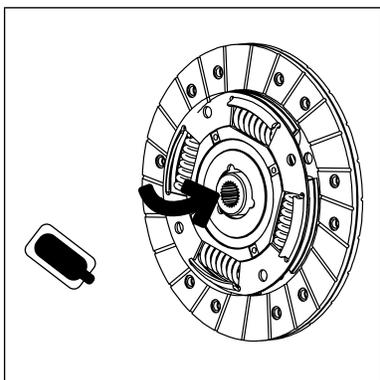
7. Aplique una pequeña cantidad de grasa de molibdeno en las ranuras del disco del embrague, el rodamiento piloto del volante, la superficie de contacto del mecanismo de liberación y el astriado de la flecha de mando.
