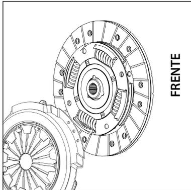
10. Verifique que el disco de embrague esté correctamente colocado con el lado elevado hacia enfrente de la placa de presión.
