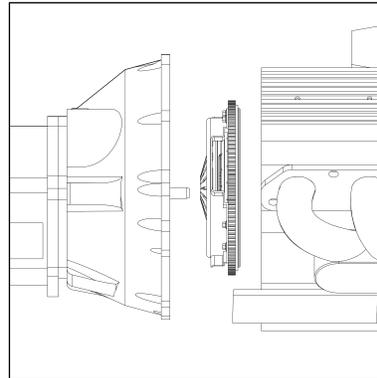
12. Instale la transmisión, revisando que el eje de entrada entre suavemente a través del balero piloto. Es importante no forzar la abertura de los pernos en la campana para acercar la transmisión al monoblock. Si es necesario, mueve el eje de entrada para alinear los dientes. Usa el soporte del gato hidráulico durante la instalación, de manera que no permitas que la transmisión quede colgando, ya que esto podría dañarla.
