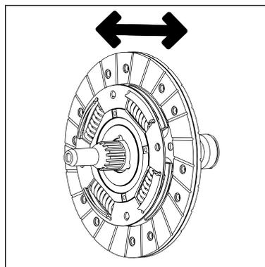
8. Verifique el movimiento de la ranura del disco de embrague, deslizando la placa a lo largo del eje de la caja de engranajes.
