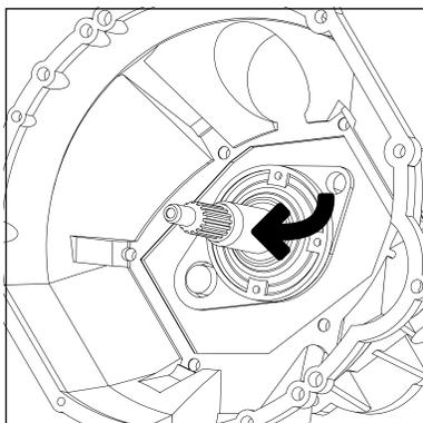
5. Verifique el estado de la superficie del candelero/tubo guía, éste debe estar en buenas condiciones y no presentar desgastes. Se recomienda hacer el reemplazo de buje piloto. (No incluido)
