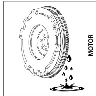
4. Revise que no haya fugas de aceite en el retén de cigüeñal, motor o en la caja de cambios; de ser así, asegúrese de detectar el problema y corregirlo inmediatamente.
