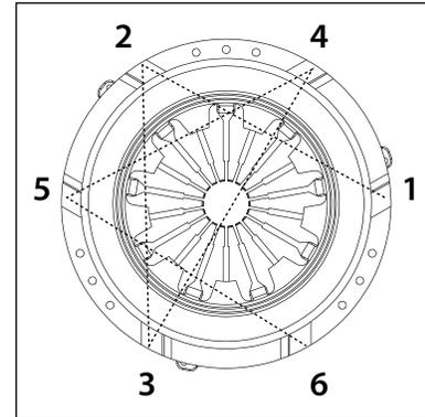
13. Apriete los pernos de fijación de la placa de presión de forma gradual y uniforme, respetando la secuencia de apriete como se indica a continuación.
