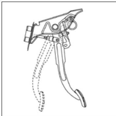
14. Verifique el correcto funcionamiento y ajuste del sistema de operación del embrague; si es hidráulico, purgue el sistema; si es de cable, ajústelo a las especificaciones del vehículo.
