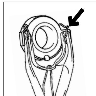
9. Revise que los seguros del collarín estén correctamente ensamblados. Observe la dirección del seguro al retirarlo.
