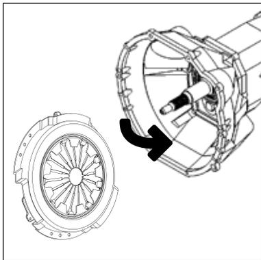
2. Elimine la suciedad y polvo del interior de la campana de embrague y de los componentes del sistema de accionamiento del embrague.
