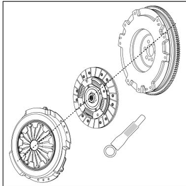
11. Use la guía o centrador de su Kit de Embrague para instalar correctamente el plato al disco.
